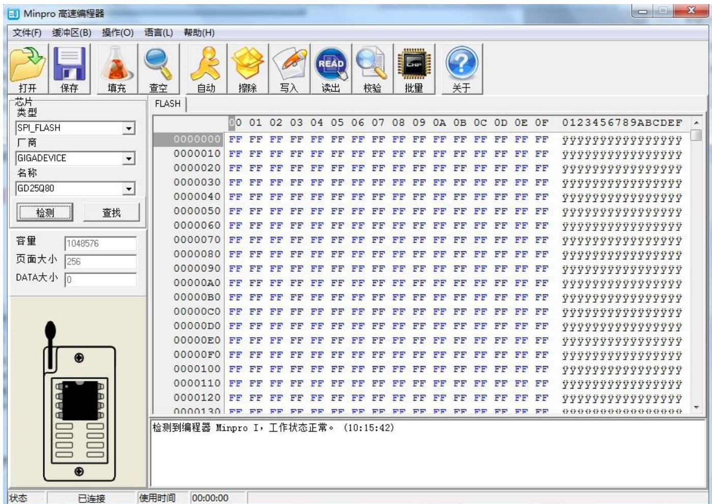
连接好编程器，打开软件，编程器就会检测到编程器型号
